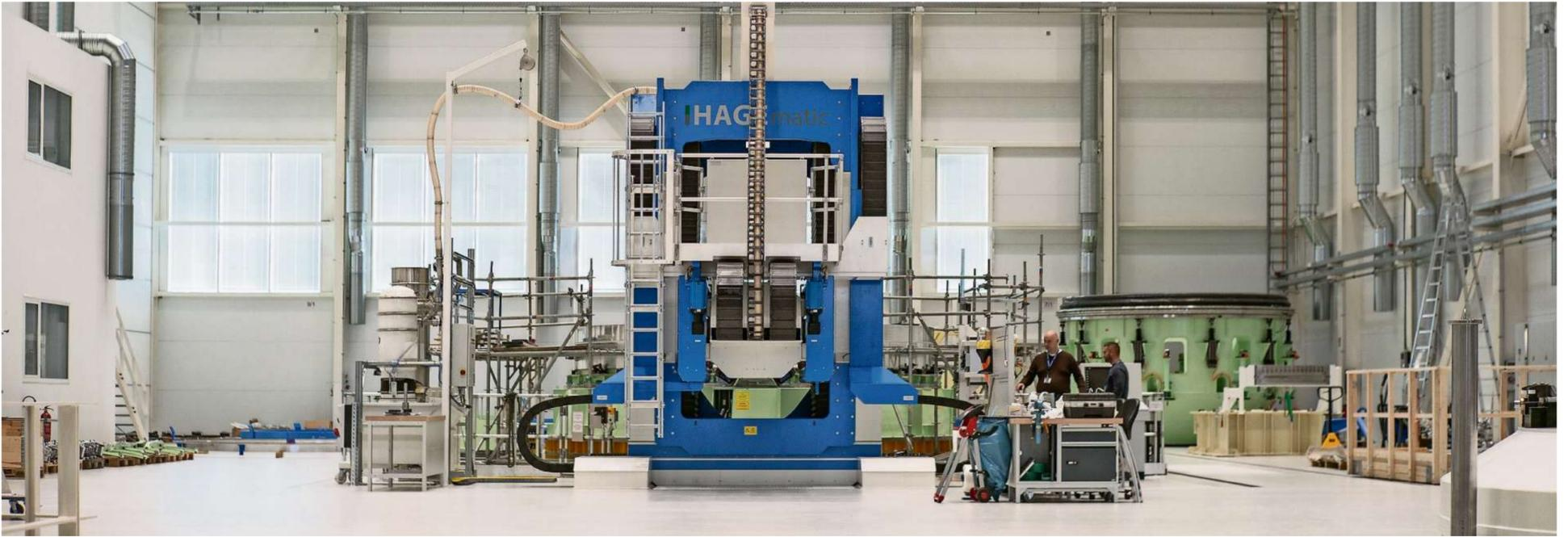
Eine Halle so groß wie ein Dom, darin nur eine Maschine: Mit Hilfe der blauen Anlage werden die Tanks für die Oberstufe der Ariane 6 bei MT Aerospace am Bremer Flughafen geschweißt.
