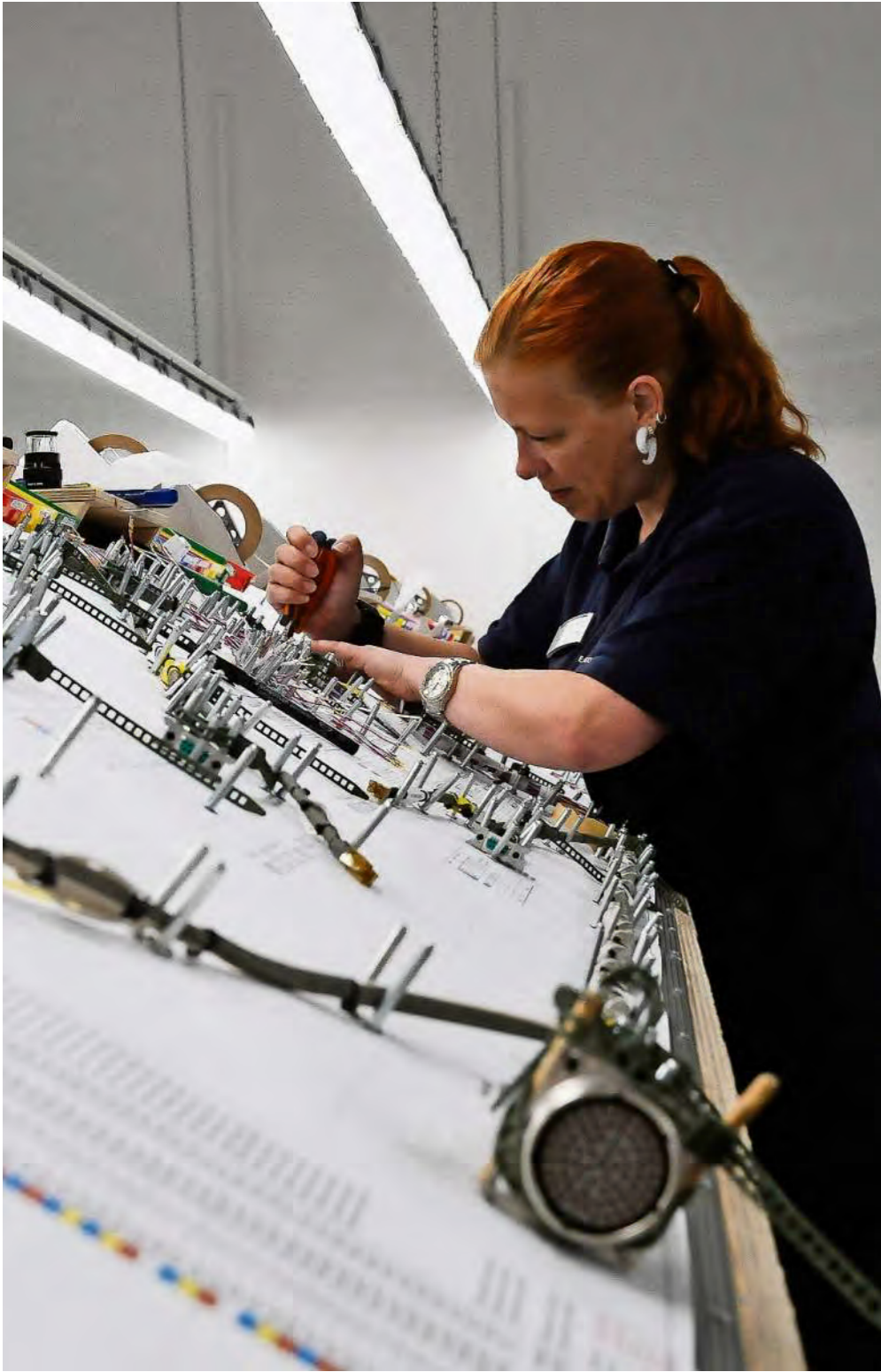
Geschicktes Drahtwerk: Konzentriert stellt eine Mitarbeiterin des Bremerhavener Unternehmens e.i.s.-electronics einen Kabelbaum für die Trägerrakete Ariane zusammen.
