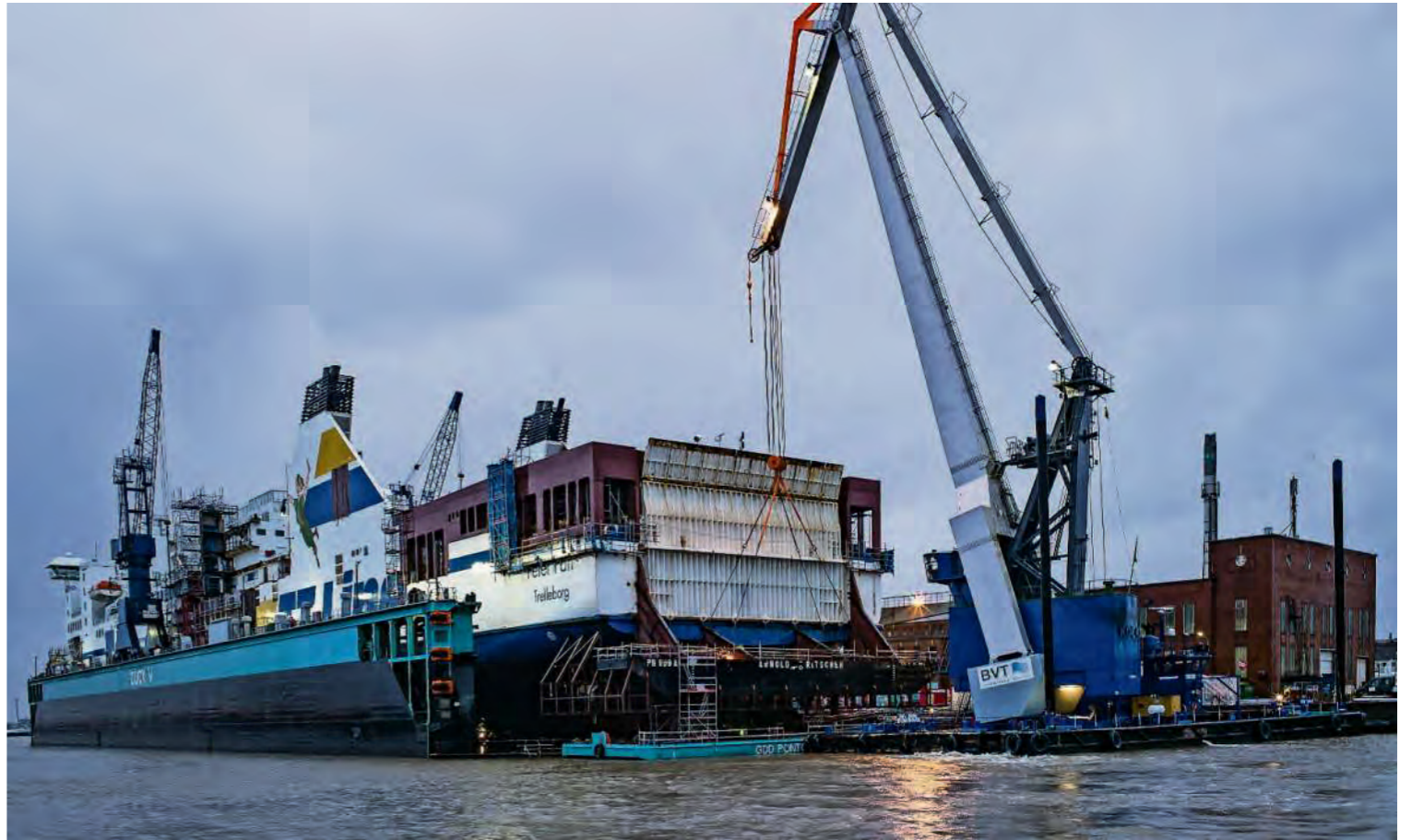
Kraftakt mit Feingefühl: Mit Hilfe eines Schwimmkrans werden die Auftriebskörper am Heck demontiert.
