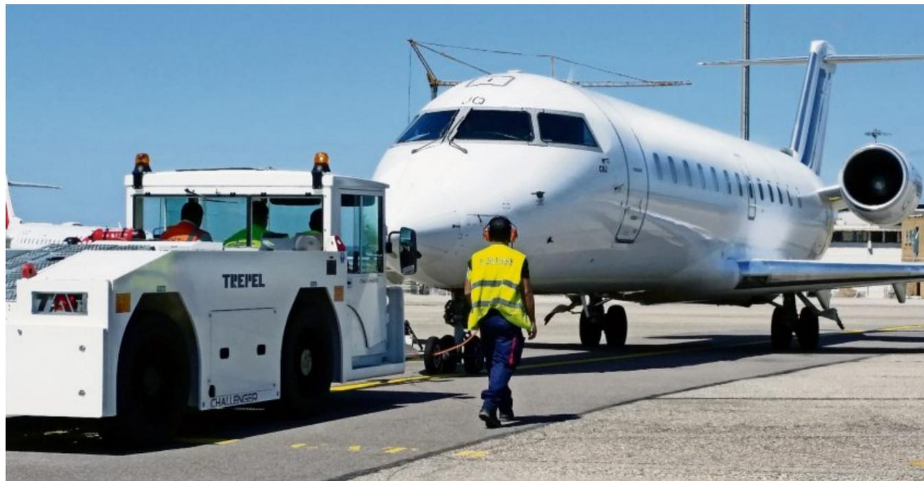
Der Challenger 150 gehört zu den Geräten, die in Bremerhaven gebaut, gewartet und überholt werden, ein Flugzeugtraktor, der vor allem zum Bewegen von Verkehrsflugzeugen der Typen Boeing 737 und Airbus 320 konstruiert wurde. Auf dieser Aufnahme zieht das Fahrzeug einen Bombardier Canadair Regional Jet.
