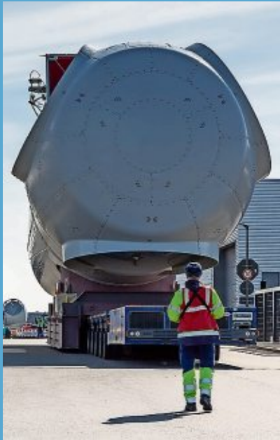
Verladung von Gondeln auf die „Rotra Vente“: Im Siemens-Gamesa-Werk in Cuxhaven werden Acht-Megawatt-Windturbinen hergestellt. Foto: Scheer/Archiv
