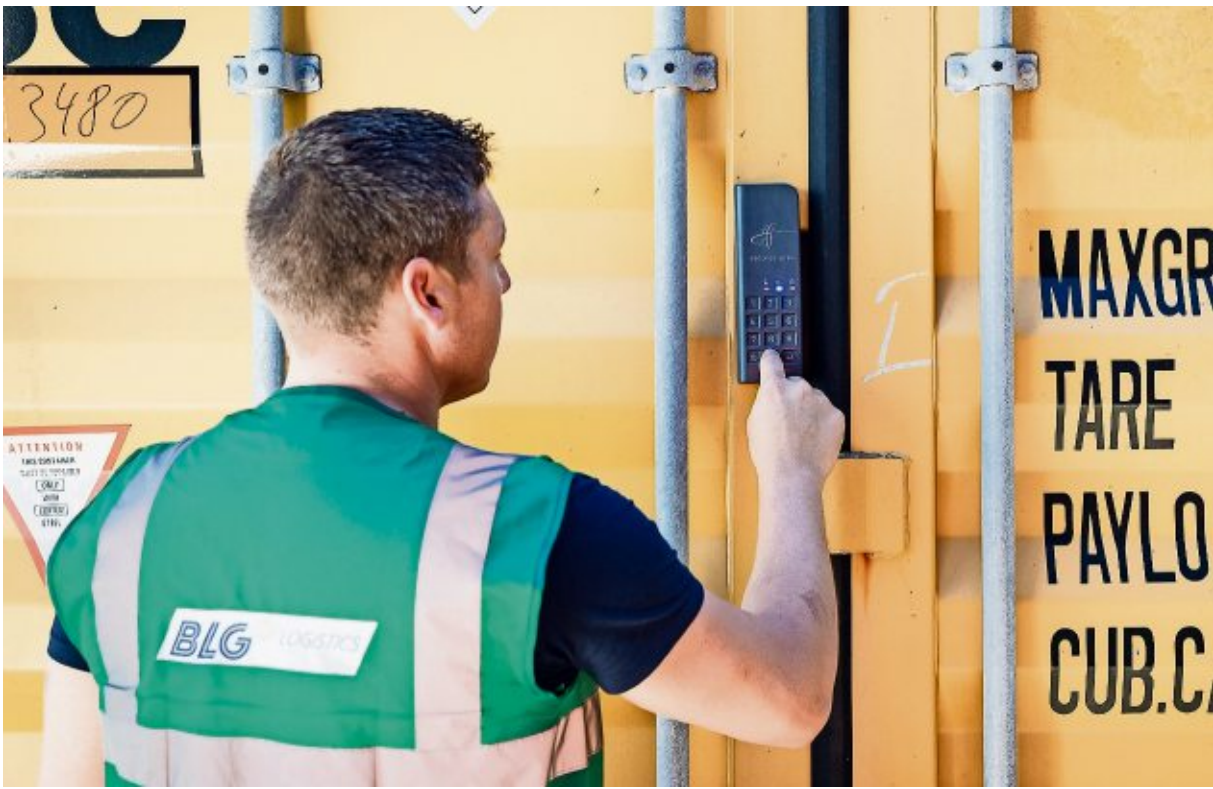
Projekt „FastLane“: Während des Transports übermittelt das Sensor-System Echtzeit-Daten bezogen auf den Ort, den Zustand und die Integrität der Container. Foto: Meier/BLG Logistics
