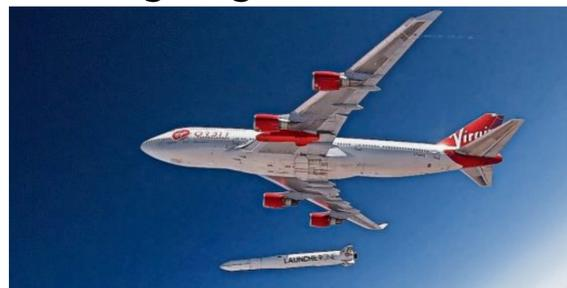
Das Air Launch-System des privaten Raumfahrtunternehmens Virgin Orbit besteht aus der Trägerrakete Launcher One, die mit einer umgebauten Boeing 747-400 in die Luft gebracht und dort abgeworfen wird. Nach drei Sekunden startet die Rakete. Ein ähnliches System wäre auch von Nordholz aus einsetzbar. Foto: Robinson/Virgin Orbit
