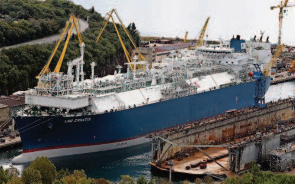
Spezialschiffe wie die „LNG Croatia“, hier in Kroatien fotografiert, könnten bald in Wilhelmshaven stationiert werden. Mit den schwimmenden LNG-Terminals kann Flüssiggas gelagert und rückvergast werden. Foto: Imago/Archiv
