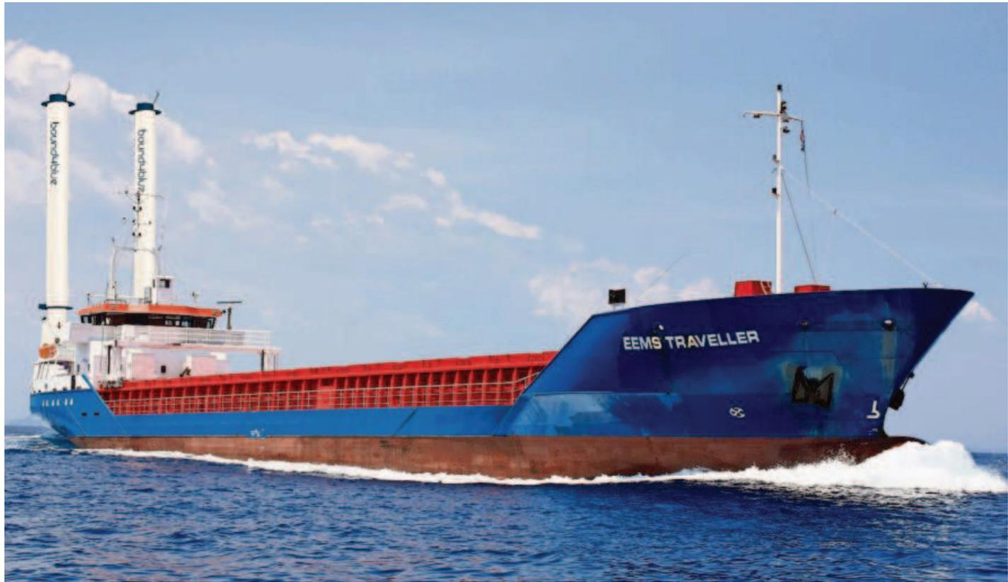
Die Neuerung des Windantriebs: Die niederländische Reederei Amasus Shipping lässt ihren Frachter „EEMS Traveller“ in diesem Jahr durch die Firma Bound4blue mit zwei 17 Meter hohen E-Sails ausstatten. Die Saugsegel sollen die Treibstoffkosten und den CO<sub>2</sub>-Ausstoß des Schiffes um bis zu 30 Prozent senken.
