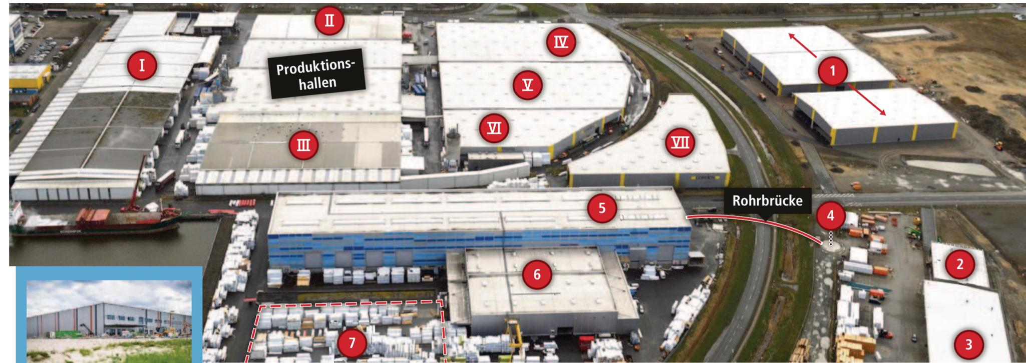
Die Cordes GmbH: Rund um die Produktion befinden sich die alten Lagerhallen (I bis VII). Neu sind drei Lagerhallen (1), vier Trockenkammern (2) und eine offene Halle (3). Im Bau ist ein Silo für Späne (4). Transportiert werden sie über eine Rohrbrücke aus dem neuen Leimbinder- und Hobelwerk (5 + 6). Außerdem entsteht eine weitere Lagerhalle (7). Foto/Grafik: Scheer/Schnibbe
