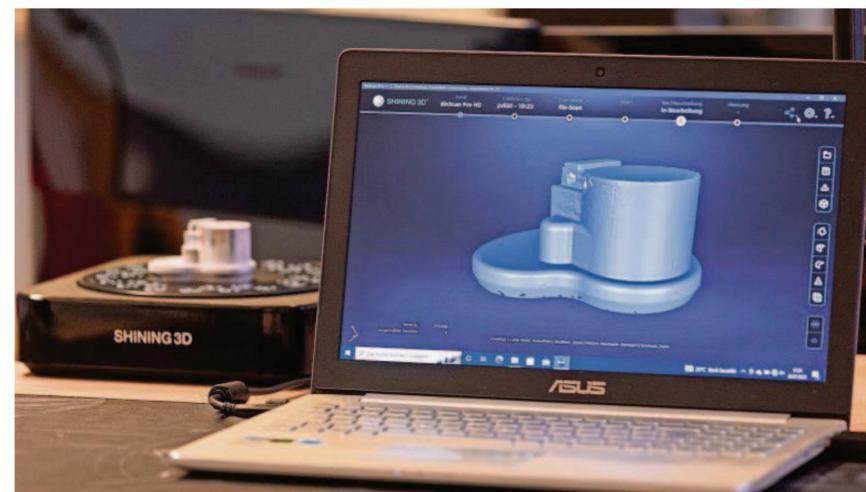
Die defekten Bereiche eines Bauteils werden digital „repariert“, danach wird per 3D-Druck das Ersatzteil zu erstellt. Foto: Sarbach/WFB
