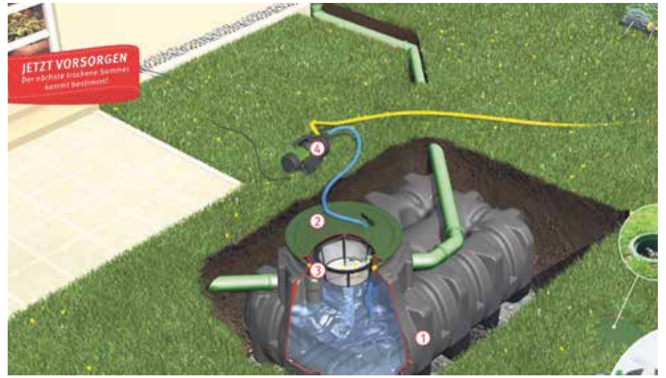
Diese Grafik zeigt einen Kunststofftank, der im Garten vergraben wird. Unter der Rasenfläche verschwindet er fast ganz – nur der Kontroll- und Reinigungsschacht ist von oben zu sehen. Beim Einbau sind allerdings auch Ver- und Entsorgungsleitungen zu berücksichtigen. Ist der Tank voll, muss das überschüssige Wasser durch den Überlauf abgeleitet werden können.
