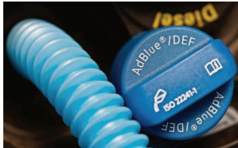
Zusatztank an Bord: Bei modernen Dieselfahrzeugen mit SCR-Kat muss von Zeit zu Zeit Adblue nachgefüllt werden.
