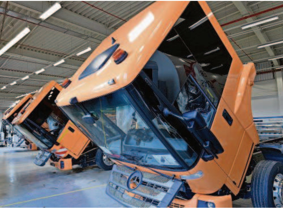
Neben Tanks, Brennstoffzellen und Akkus erhalten die Fahrgestelle in Bremen eine ausgefeilte Elektronik, welche die neuen Komponenten steuert.
