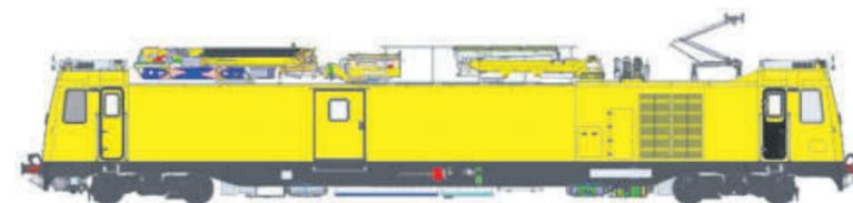
So etwa soll die neue Hybrid-Generation aussehen: eine Designstudie für ein Entstör- und Instandhaltungsfahrzeug für Oberleitungsanlagen. Quelle: Harsco Rail
