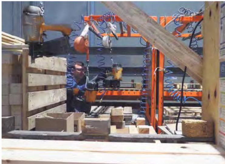
An diesen Reparaturplätzen werden beschädigte Paletten wieder fit gemacht. Die ausgebauten Bestandteile werden gesammelt und ins Palettenwerk nach Wismar gefahren – sie dienen zum Heizen.
