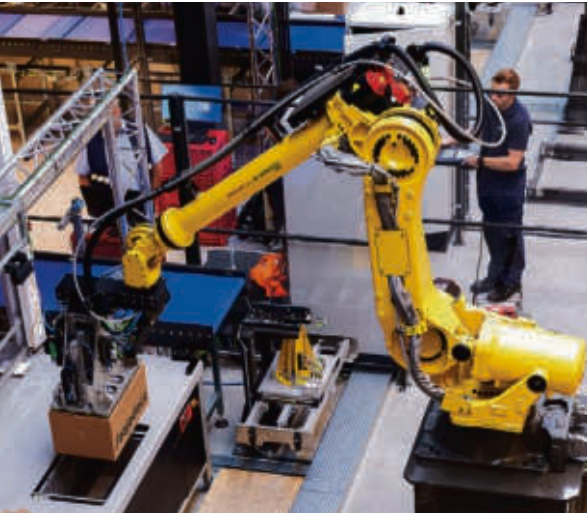
Ein Roboterarm stapelt die versandfertigen Pakete auf Paletten. Zwei dieser Maschinen sind im Einsatz.
