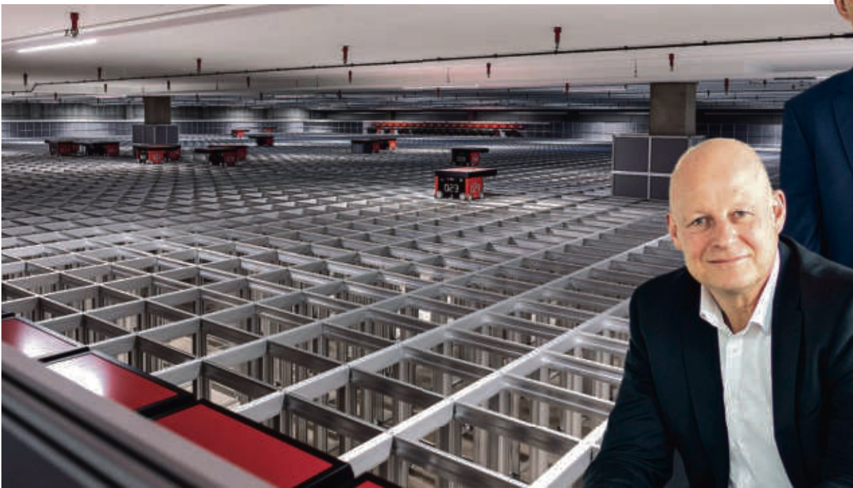
Die 52 Roboter bringen jeden der 64 000 Behälter der AutoStore-Anlage immer sicher und schnell ans Ziel. Die Boxen werden übereinander eingelagert.
