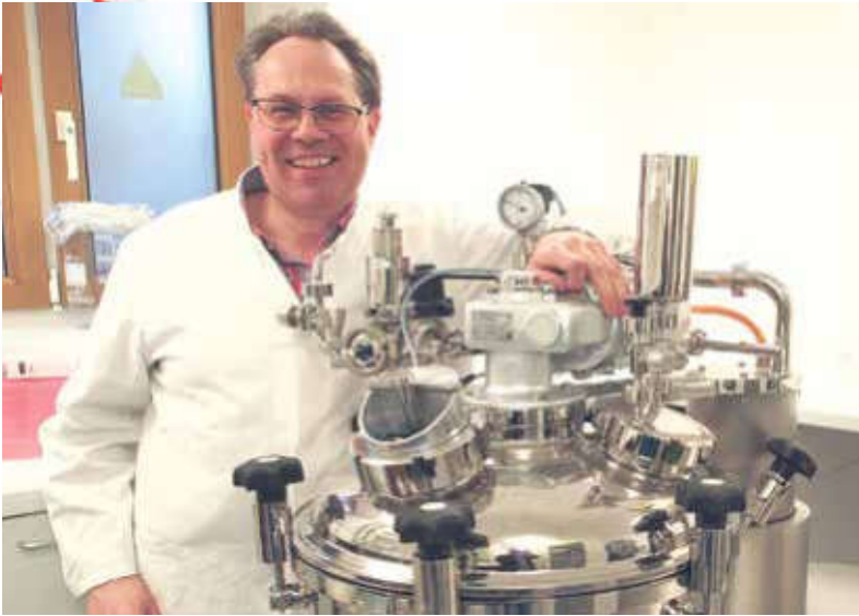
Schafft 10 000 Umdrehungen und enthält ein Planetenrührwerk: Der Becomix-Mischer ist das Herzstück der neuen Arzneimittelproduktion, die Friedrich Menges derzeit im Keller der Schäfer-Apotheke in Harburg aufzieht.
