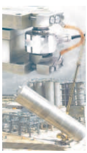
LINKS OBEN: Mobil und mit Funk ausgestattet: die Rad- und Achslastwaage. LINKS: Hier kommt es auf jedes Gramm an: Andreas Sawall (von links), Uwe Mix und Kilian Mix vor den Eichgewichten, mit denen sie Waagen im Industriebereich korrekt justieren. RECHTS: Die Wägezellen (oben) sind direkt an den Stützen eines Silos montiert, nehmen also die gesamte Last auf und melden sie an eine zentrale Kontrolleinheit.
