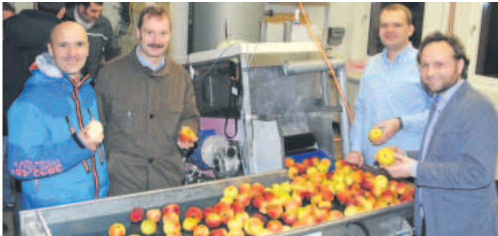
Das ist der Prototyp der Apfeldusche: Karl Schloffer (von links), Dr. Roland Weber, Dr. Peter Maxin und Hinrich Holthusen vom Obstzentrum Esteburg sehen in der Kurz-Heißwasserbehandlung mit der Apfel-Dusche eine Alternative zu Lagerspritzungen.
