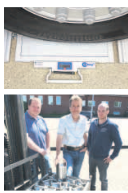
LINKS OBEN: Mobil und mit Funk ausgestattet: die Rad- und Achslastwaage. LINKS: Hier kommt es auf jedes Gramm an: Andreas Sawall (von links), Uwe Mix und Kilian Mix vor den Eichgewichten, mit denen sie Waagen im Industriebereich korrekt justieren. RECHTS: Die Wägezellen (oben) sind direkt an den Stützen eines Silos montiert, nehmen also die gesamte Last auf und melden sie an eine zentrale Kontrolleinheit.
