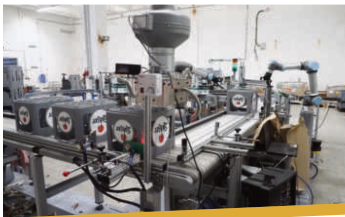
Hightech bei Cleanaway Logistic: Hier wird aus einem Lübzer-Kasten ein Holsten-Kasten – Roboter entfernen das alte Label, die Etikettiermaschine beklebt den Kasten neu.
