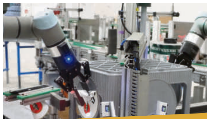
Hightech bei Cleanaway Logistic: Hier wird aus einem Lübzer-Kasten ein Holsten-Kasten – Roboter entfernen das alte Label, die Etikettiermaschine beklebt den Kasten neu.
