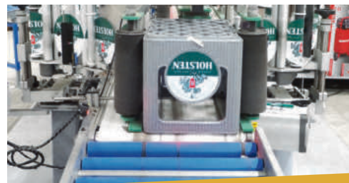
Hightech bei Cleanaway Logistic: Hier wird aus einem Lübzer-Kasten ein Holsten-Kasten – Roboter entfernen das alte Label, die Etikettiermaschine beklebt den Kasten neu.
