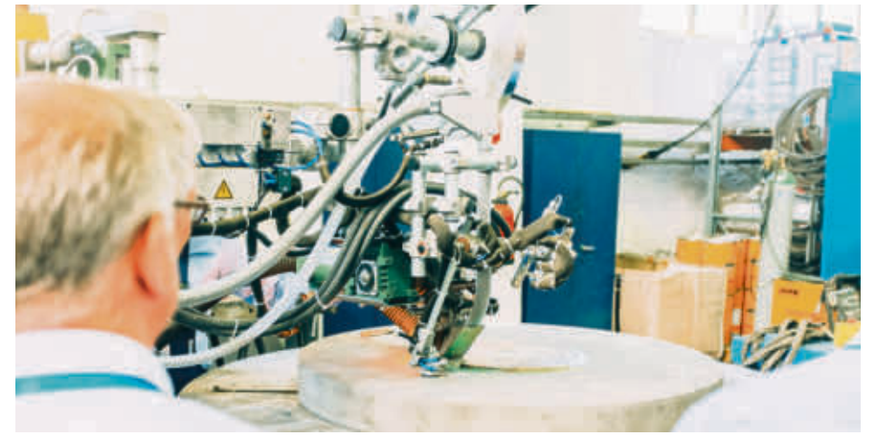
Blick in die Fertigung: Demonstration des Elektroschlackebandplattierens vor Fachpublikum. Links: Noch ein Blick in die Fertigung der Mayr & Wilhelm GmbH und Co. KG: Das Foto zeigt den „Mantelschuss in Rollenbockdrehvorrichtung, bereit zum Unterpulverschweißen“.
