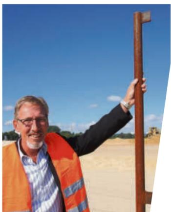
Diese Messpegel sind überall auf der Fläche verteilt. Sie senken sich mit der Sandplatte langsam ab und geben Aufschluss über den Setzungsvergang.
