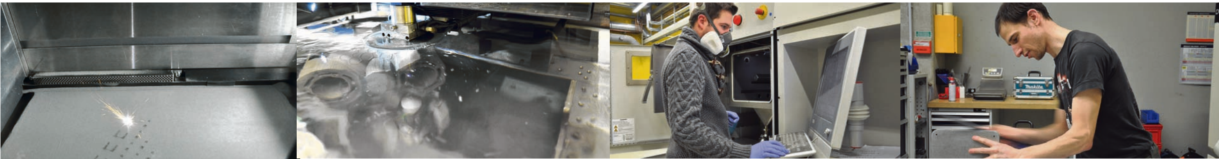
Ultraleichte Titanteile aus dem 3D-Drucker: Pulverförmiges Metall wird mit dem energiereichen Licht eines Faserlasers bestrahlt und dadurch aufgeschmolzen.
