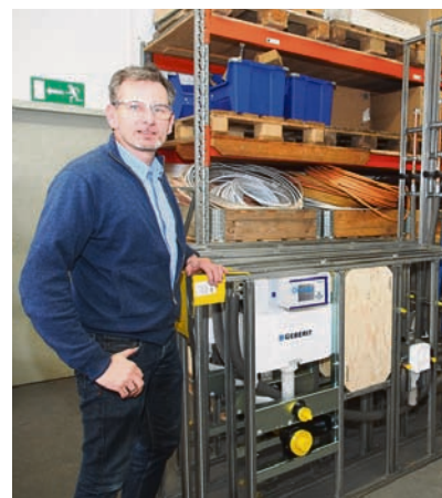
Rainer Kalbe steht vor bereits vormontierten Modulen, die in der Werkstatt am König-Georg-Stieg in Wilhelmsburg für Bäder in einer Reihenhäuszeile vorbereitet worden sind.
