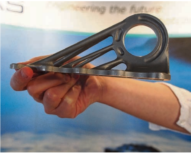
Diese aus Titan gedruckte Halterung wurde auf dem Hamburg Innovation Summit 2015 als „erstes fliegendes Teil aus der 3D-Fertigung“ präsentiert. Es stammt aus dem Kabinenbereich der A350.
