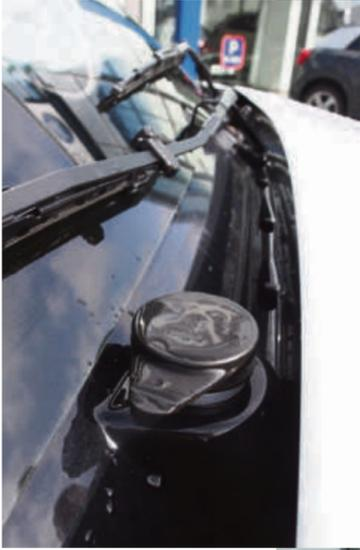
Unkonventionell: Wischwasser kann ohne Öffnen der Motorhaube nachgefüllt werden – eine Erleichterung für die Betreiber von Fahrzeugflotten.
