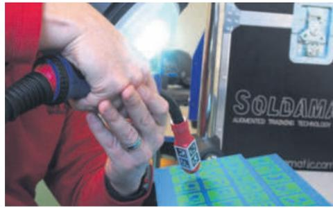
Der Schweißbrenner muss im korrekten Abstand und Winkel mit konstanter Schweißgeschwindigkeit zum Werkstück geführt werden.
