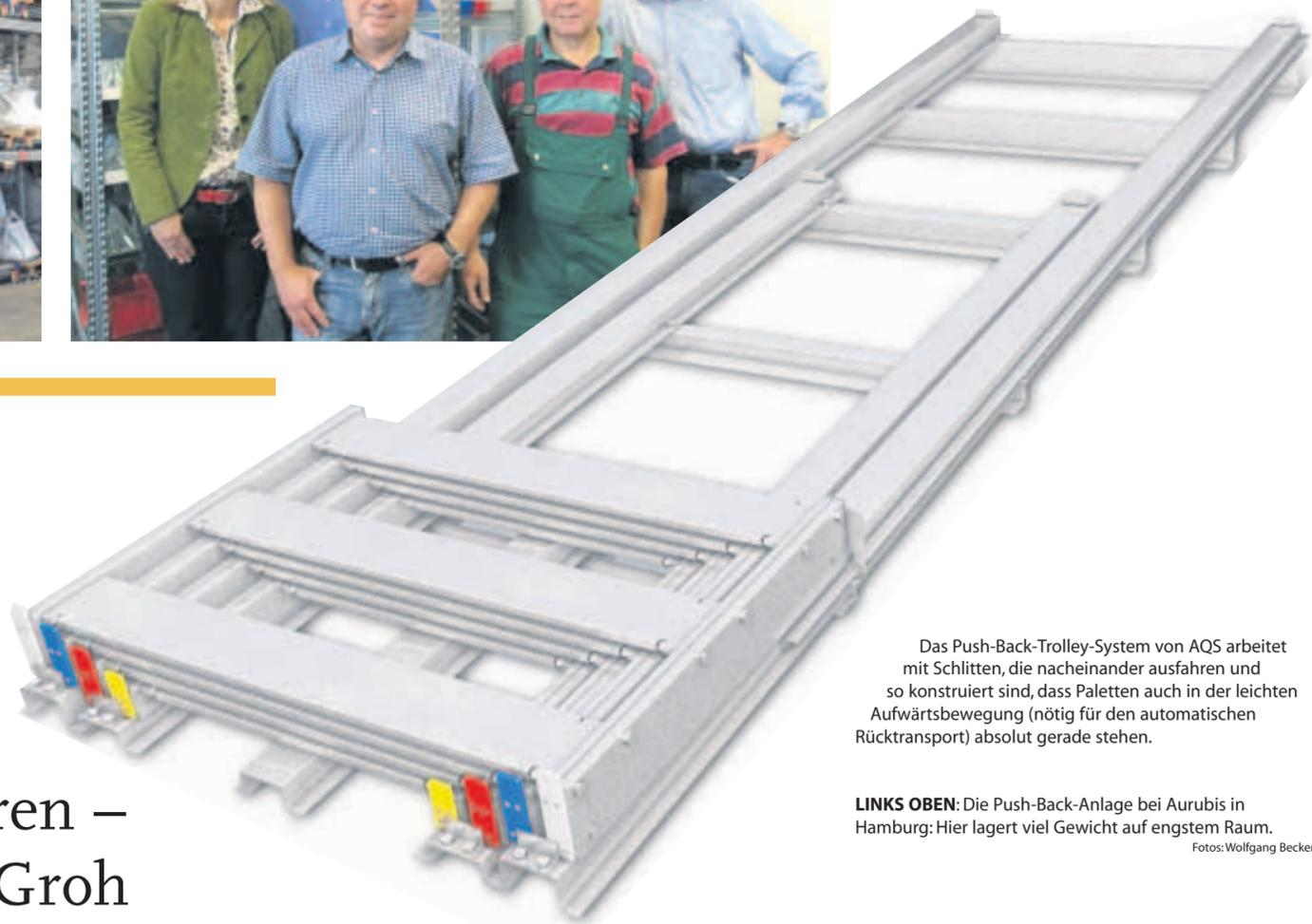
Das Push-Back-Trolley-System von AQS arbeitet mit Schlitten, die nacheinander ausfahren und so konstruiert sind, dass Paletten auch in der leichten Aufwärtsbewegung (nötig für den automatischen Rücktransport) absolut gerade stehen.
