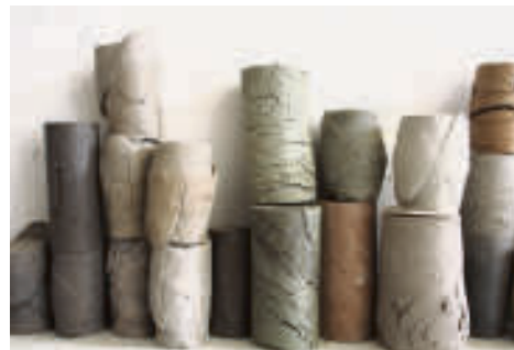
Die Untersuchung von Bohrkernen aus dem Untergrund in Norddeutschland dominierenden „Lockergestein“ gehört zum Standardprogramm.
