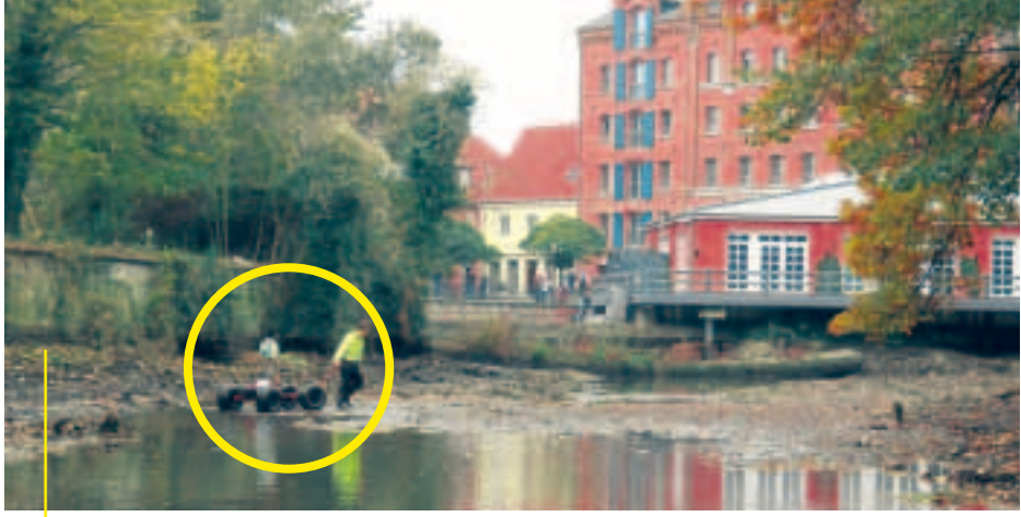
Kinematisches Laser-Scanning: Der Scanner ist auf einem Wagen montiert und wird durch das trockene Flussbett der Ilmenau gezogen.
