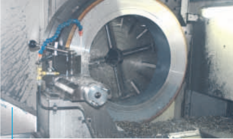
Zerspanung: Bei hoher Drehzahl trägt das Werkzeug den Stahl ab.
