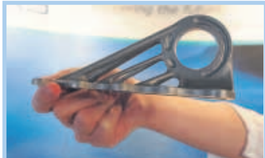
Bereits eingebaut: Diese Halterung fliegt in der Airbus-Kabine – der Flugzeugbauer prüft derzeit intensiv, welche Teile sich noch zum Drucken eignen.
