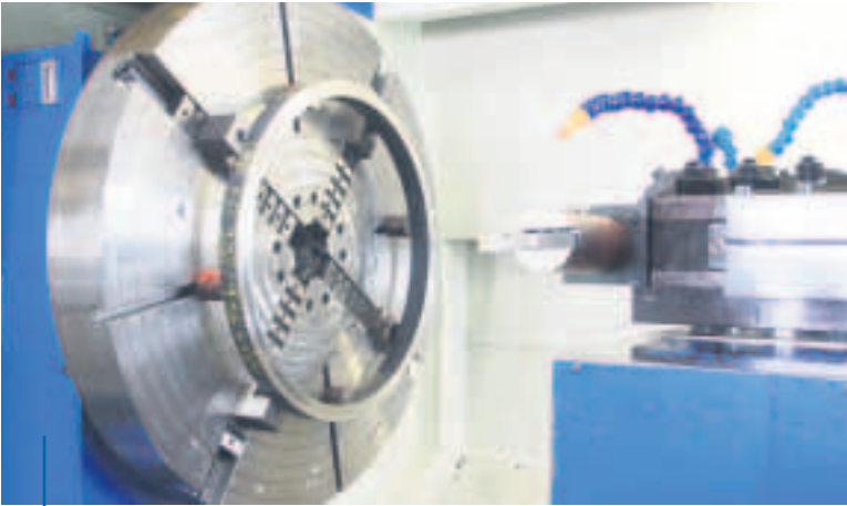
Auf der zyklengesteuerten Großdrehmaschine können Werkstücke bis 180 Zentimeter Durchmesser bearbeitet werden.
