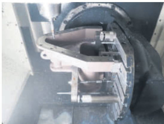
Ein Bauteil für eine Landmaschine ist fertig bearbeitet, aber noch eingespannt.
