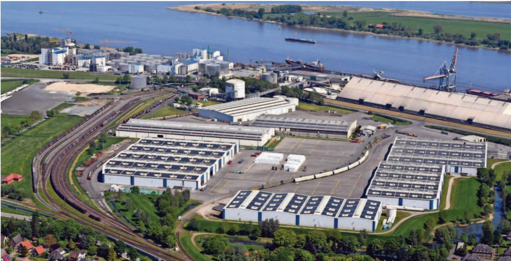
Die J. Müller-Photovoltaikanlage im Braker Hafen umfasst insgesamt zehn Hallendächer mit einer Gesamtfläche von 62.100 Quadratmetern.
