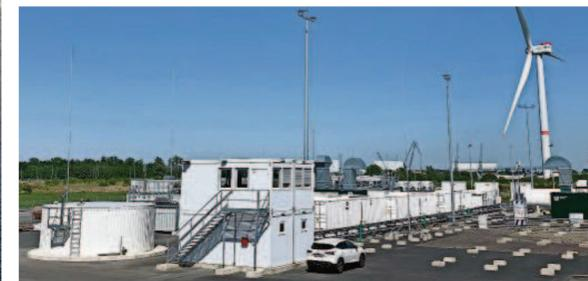
Das Becken des Meerwasserprüfstands auf dem Hydrogen Lab Bremerhaven, mit PEM-Elektrolyseur und Windenergieanlage im Hintergrund.
