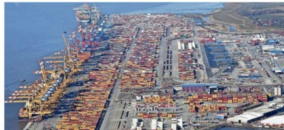
Die Automatisierung des Containerterminals beginnt auf der neuen Bahnumschlaganlage (rechts): Die blauen Portalkräne werden vom Büro aus gesteuert. Foto: Scheer
