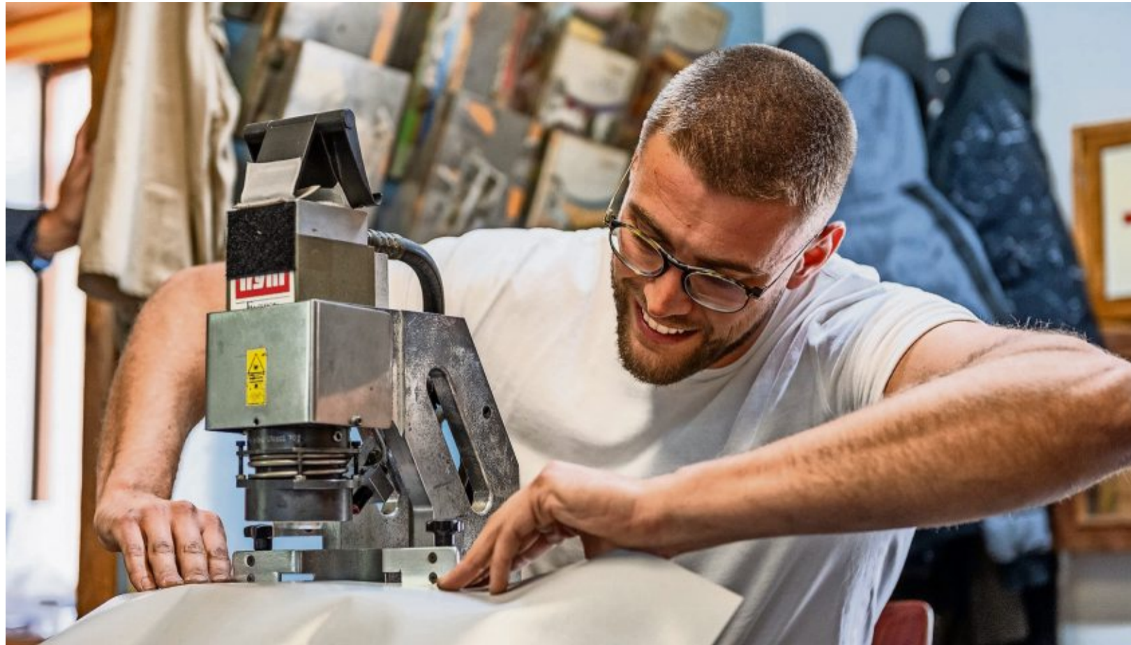
Tim Strelow, der sich derzeit das Segelmacherhandwerk aneignet, arbeitet an der Ösemaschine, die den zuvor rein manuellen Ablauf teilweise automatisiert.
